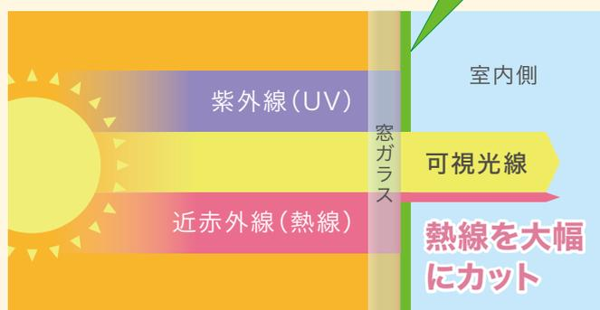
既存のガラスに塗るだけのエコガラスコート。透明性に優れたコーティング膜は、太陽光の暑さの原因である近赤外線(熱線)を大幅にカットします。
